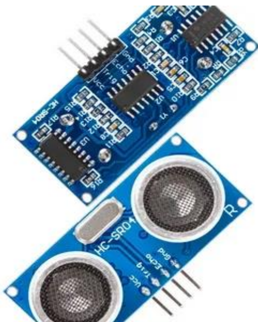
2.6-сурет – HC-SR04 қашықтықты өлшейтін ультрадыбыстық диапазоны
